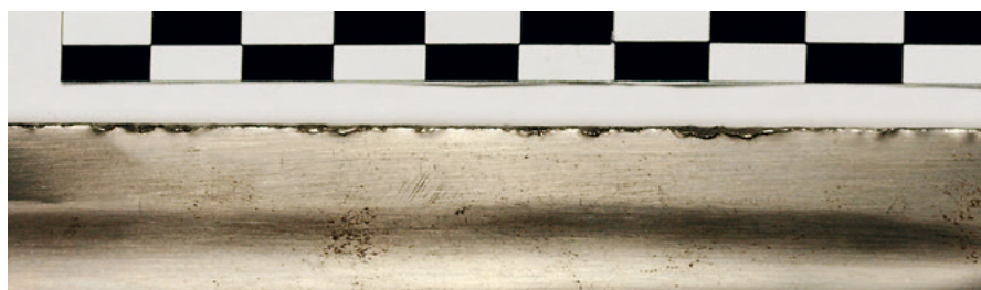
Obr. 2.2.5 Detail ostří „bastardu“ z pružinové oceli.
