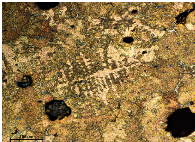
obr. 1.1.2 Optická metalografie fragmentu meče, zvětšeno 200× (meč č. 13678.1 Lažany; Křišťuf et al. v přípravě).
